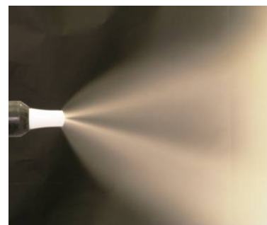
слишком много продувочного воздуха для электродов
